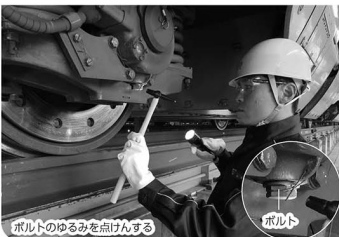
ボルトのゆるみを点検する
